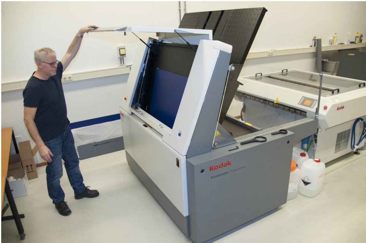
CTP operator Fons Harmsen bij de nieuwe Kodak Q800 Trendsetter plaatbelichter
